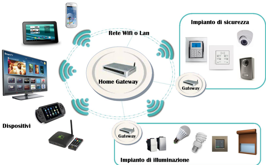
Figura 1.1. Schema generale di una casa intelligente.
