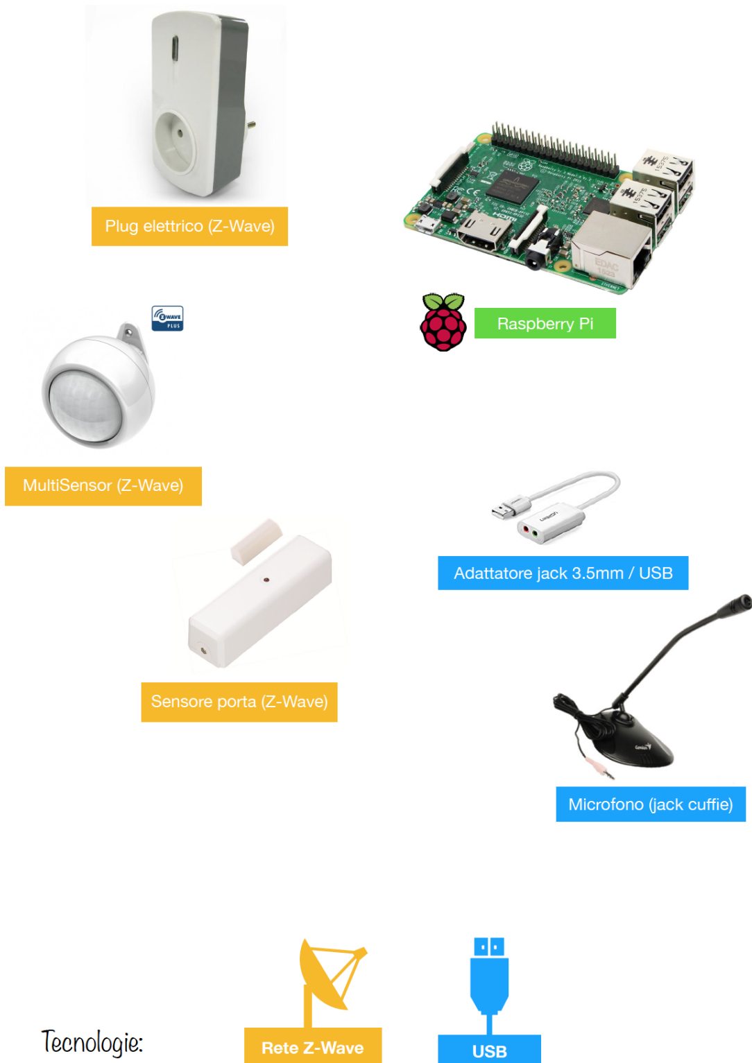
Figura 4.3. Dissezione dei componenti di una stazione di rilevamento
