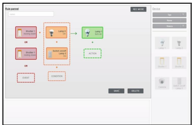
Figura 1B. Esempio di regola composta con il prototipo dell'interfaccia click realizzato al PC.
